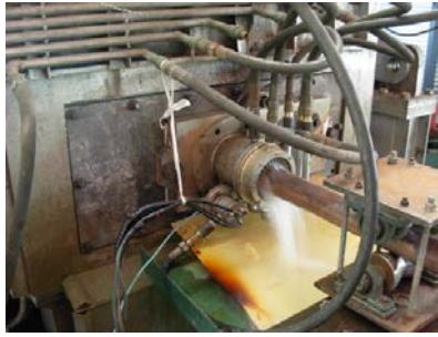
图3 铸坯的铸造现场图图4 铸造成50m的Cu-Cr-Zr棒坯 图7 京沪高铁的接触线
